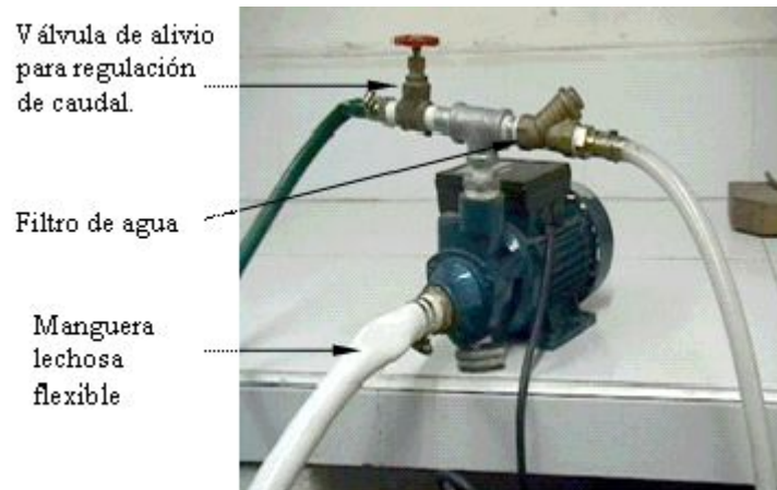
Figura 2.2 Bomba de agua con válvula de alivio
