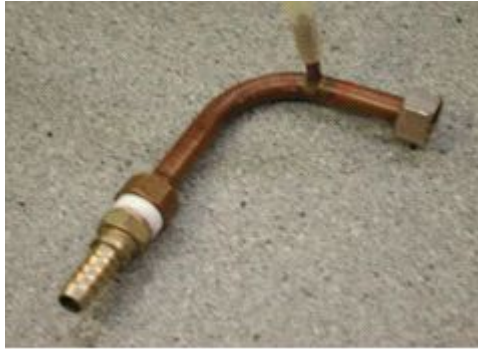
Figura 2.7. Conector en cobre acoplable a la entrada de gas
