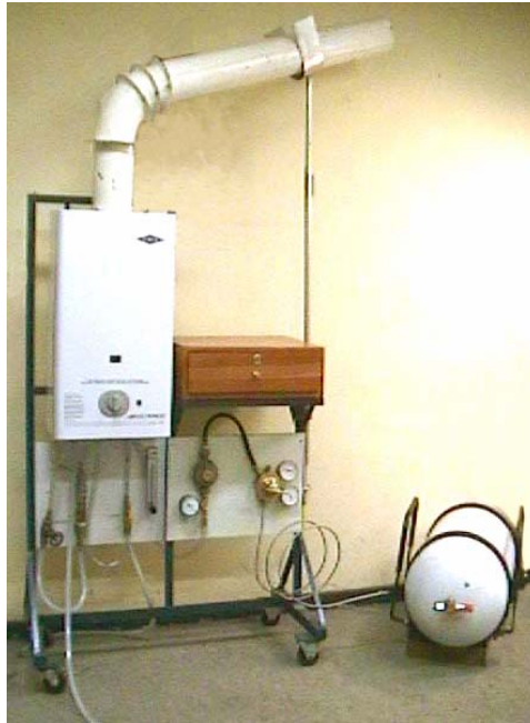
Figura 2.1. Tutor de pruebas para calentadores de paso a gas natural
