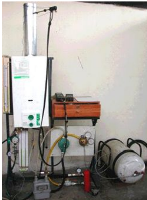
Figura 2.13 Tutor de pruebas para calentadores de paso a gas natural luego de las modificaciones
