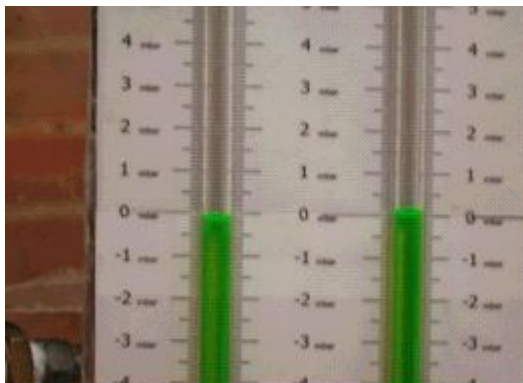
Figura 2.9. Detalle escala en milibares del manómetro en U
