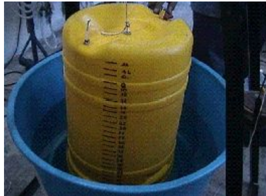
Figura 2.14 Campana invertida para la calibración y comparación de instrumentos para flujo de gas
