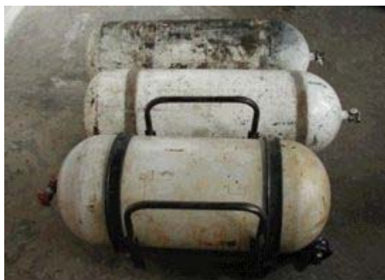
Figura 4.1 Tanques almacenamiento de gas vehicular
