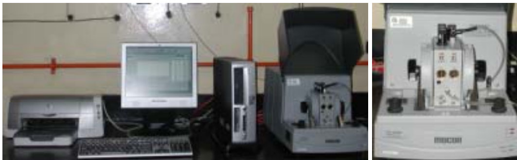
Imagen 3. Equipo para medición de permeabilidad al oxígeno
