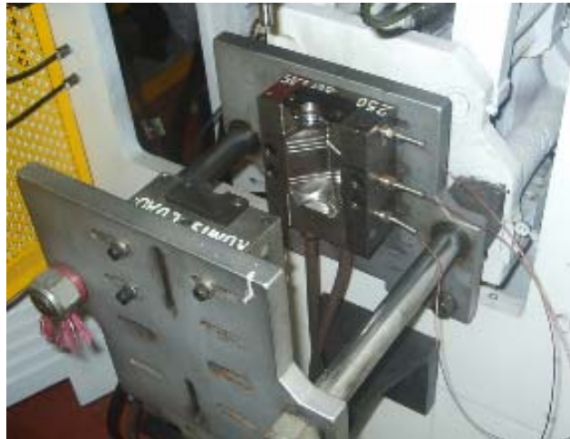
Figura 9. Instrumentación del molde de soplado mediante termopares tipo J.
