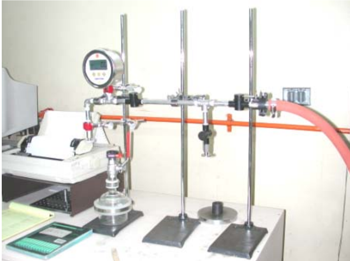
Figura A.3. Parte 2 del equipo. Sistema de carga de gases y medición de presión.
