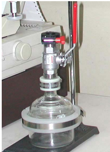
Figura A.2. Botella de vidrio con válvula en acero inoxidable.
