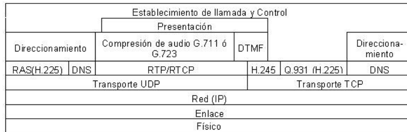
Figura 2. . Pila de protocolos para VoIP según la recomendación H.323.[14]
