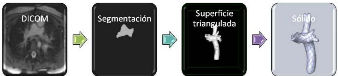
Figura 4.7: Pasos usualmente requeridos para la obtención de un modelo sólido a partir de una serie de imágenes diagnósticas.
