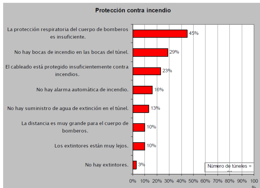
Figura 11. Deficiencias encontradas en el apartado de Protección contra incendios.
