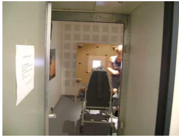
Ilustración 9: Caja de Faraday para llevar a cabo las pruebas clínicas y adquirir las señales EEG.
