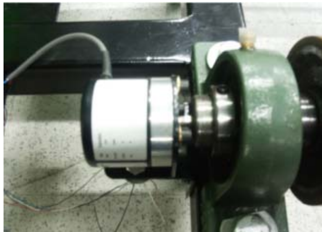
Ilustración 3. Encoder Stegmann S1 instalado en los rodillos del banco de prueba
