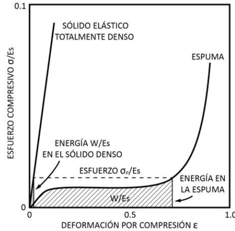
Figura 7: Curvas esfuerzo-deformación para un sólido elástico y una espuma desarrollada con el mismo material [2].
