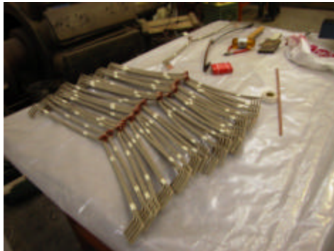
Ilustración 7. Bobinas equipotenciales fabricadas por Inteleca LTDA.
