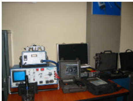
Ilustración 12. Equipos de pruebas Baker, junto con el analizador de vibraciones, el laser y el estatoscopio.
