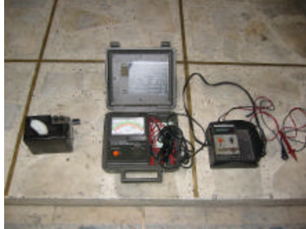
Ilustración 13. Equipos Meger de 5000, 1000 y 500 voltios.
