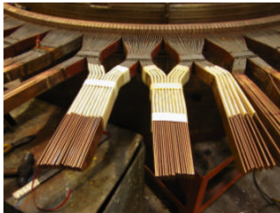
Ilustración 8. Colector con delgas amarradas en motor de 5000 HP 100 RPM, reparado por Inteleca LTDA
