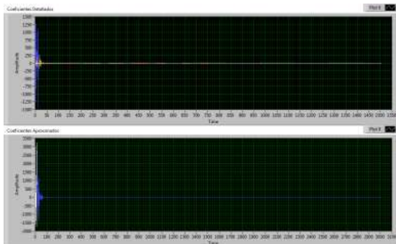
Figura 14. Coeficientes detallados y aproximados de Wavelet para la simulación en LabVIEW para una señal seno de fenómeno sag
