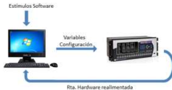
Figura 1 Esquema de simulación RT-HIL
