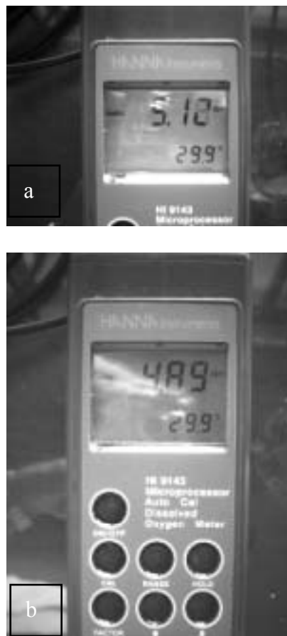
Figura 8. Medidor digital de oxígeno disuelto (Oxímetro) y temperatura (T°) marca HANNA INSTRUMENTS ref. HI 9143.
