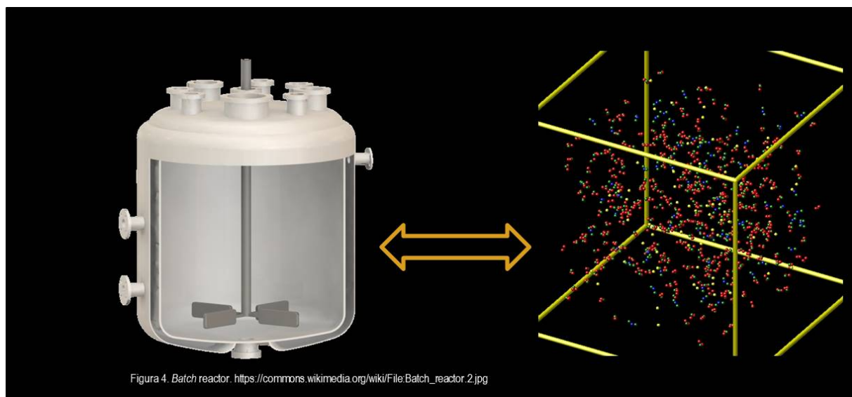
FIGURA 1: Analogía entre sistema presurizado y caja de simulación (Imagen del reactor tomada de https://commons.wikimedia.org/wiki/File:Batch_reactor.2.jpg ).
