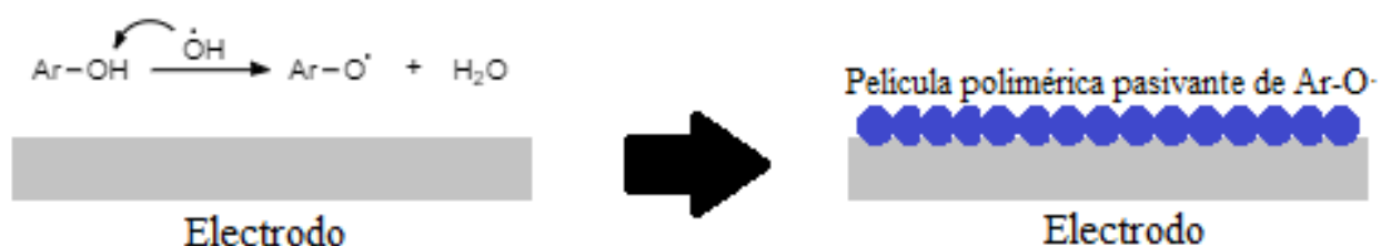
Figura 3. Envenenamiento de electrodo.
