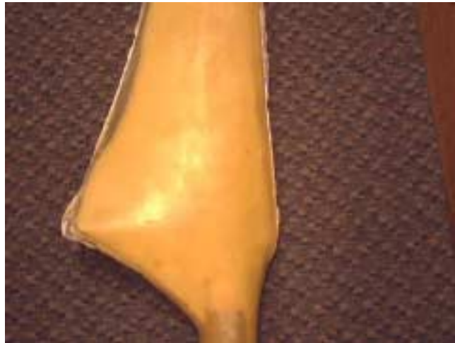
Foto 20. Zona de la raíz del aspa luego de la prueba de fatiga
