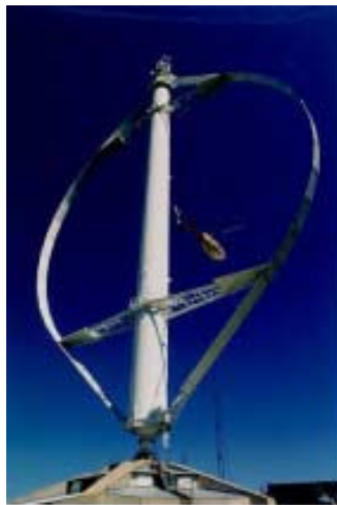
Figura 12. Aerogenerador de eje vertical. Tipo Darrieus.
