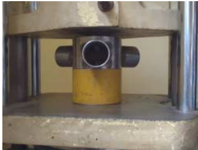
Foto 13. Vista del montaje del cubo sobre el soporte en la máquina Tinius
