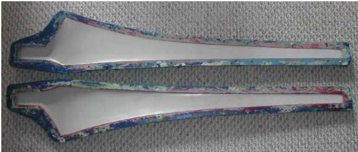
Foto 6. Molde abierto en dos partes.
