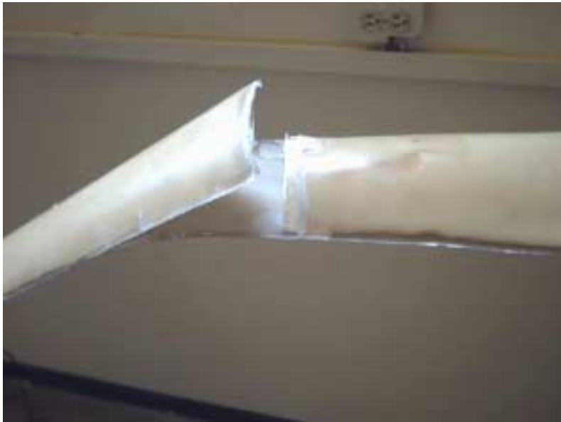
Foto 18. Falla típica de las aspas rellenas con Poliuretano
