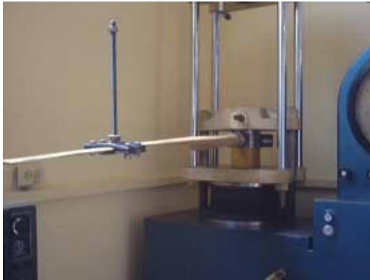
Foto 14. Dispositivo para carga del aspa
