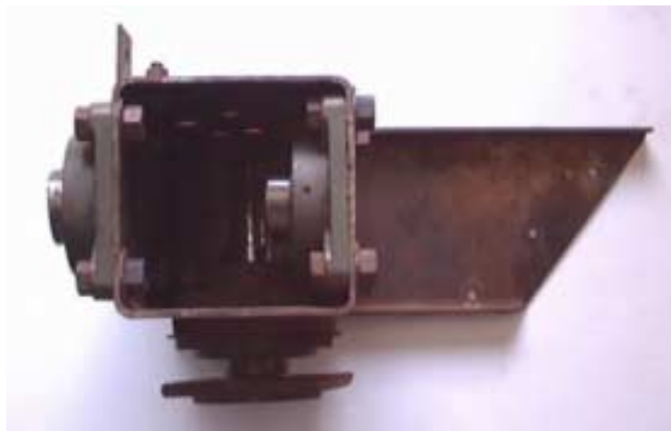
Foto 28. Estructura de fijación del rotor a la torre
