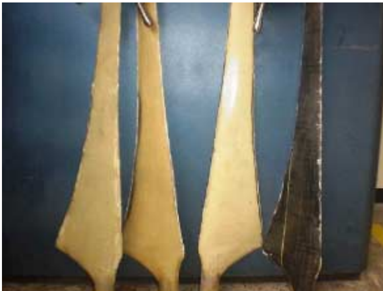
Foto 12. Aspas compuestas de CFRP o GFRP con Poliuretano.
