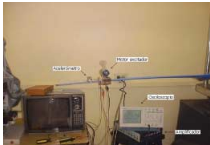
Foto 19. Determinación de la frecuencia natural de las aspas.
