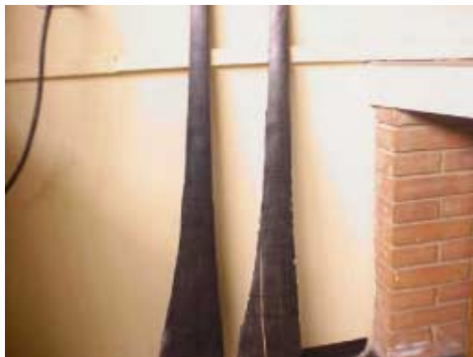
Foto 10. Aspas huecas de tela de fibra de carbono.
