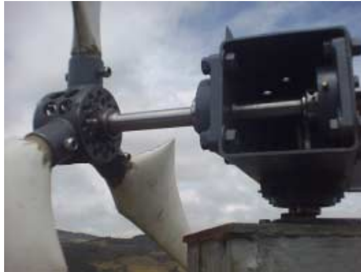
Foto 29. Acople del rotor eólico a la estructura
