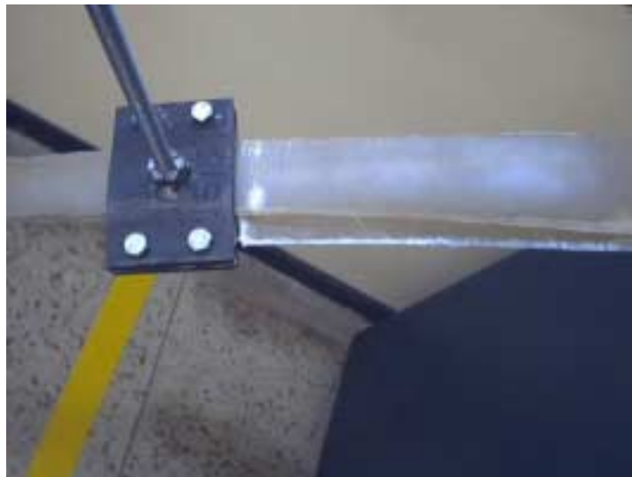
Foto 17. Falla típica de las aspas huecas
