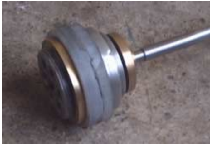
Figura 3. Válvula viajera armada con el vástago metálico y el sello de HDPE.
