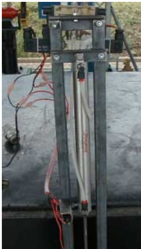
Figura 9. Detalle de la electroválvula y el actuador neumático con sus respectivos acoples.
