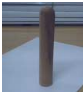
Figura 16. Modelo de madera con sellador sobre el cual se hacen las probetas.
