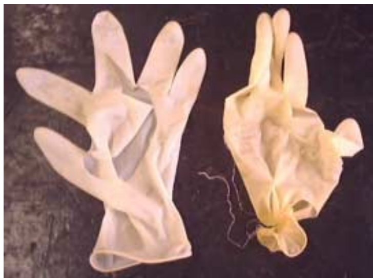
Figura 14. Guantes de látex después de la prueba de presión.
