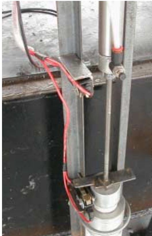
Figura 10. Detalle de los controles de carrera anclados a la estructura.
