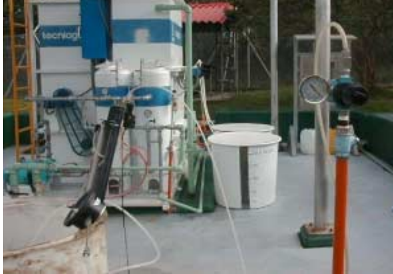
Figura 19. Montaje de prueba con manómetro y recipiente de succión.
