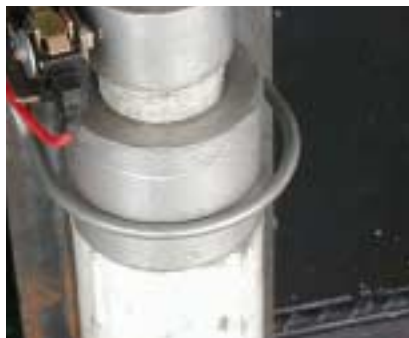
Figura 5. Detalle de prensa estopa con su respectiva alojamiento ya acoplado.
