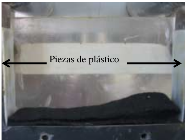
Foto 3.4: Sistema de drenaje inferior en el contenedor de la centrífuga.
