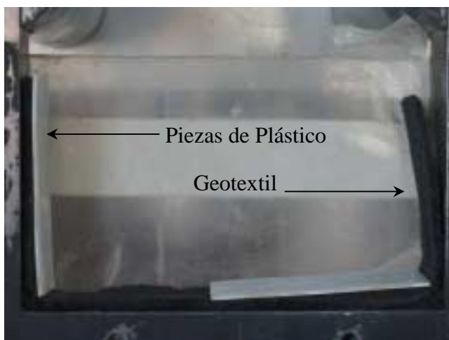
Foto 3.21: Sistema de drenaje ineficiente.
