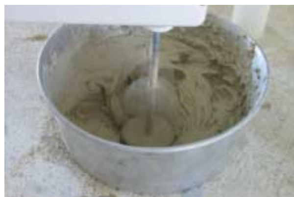
Foto 3.9: Caolín mezclado a una humedad igual a 1.5W_{LL} . Como resultado se observa una mezcla homogénea y 100% saturada.
