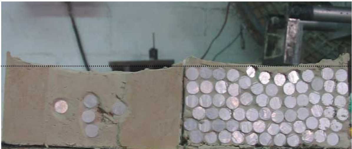
Foto 3.33: Mezclas binarias con 5 y 70 inclusiones. En la Fotografía se observa la diferencia en los asentamientos bajo la misma carga.
