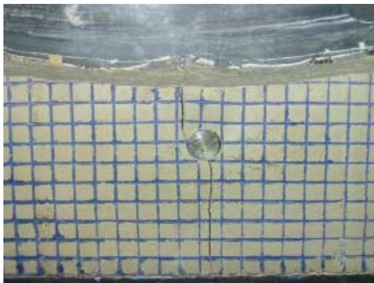
Foto 3.17: El movimiento de la centrífuga a gran velocidad crea una corriente de aire que seca la muestra hasta agrietarla. Para evitar lo anterior se selló el contenedor de la centrífuga como se indica en la Foto 3.13.
