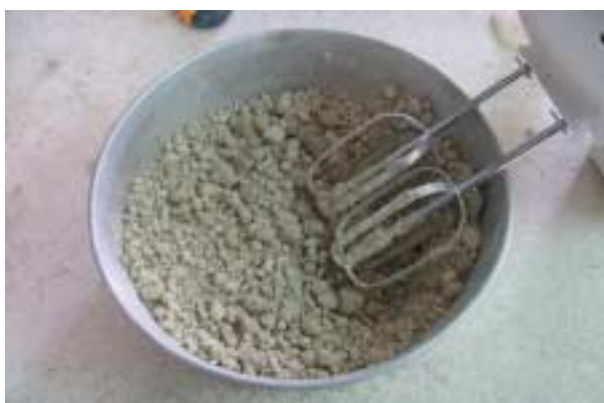
Foto 3.8: Caolín mezclado a una humedad inferior a 1.5W_{LL} . Después de batir durante 20 min. se observan grumos secos de caolín.
