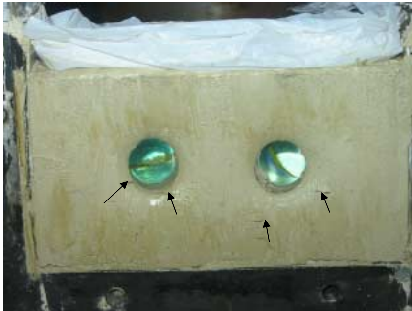
Foto 3.19: Modelo con inclusiones esféricas colocada después de consolidar el caolín. La inserción de esferas induce fuerzas de tensión que se traduce en algunas grietas de tracción en la masa arcillosa. También se observa que no existe un contacto perfecto entre las esferas y la masa arcillosa.
