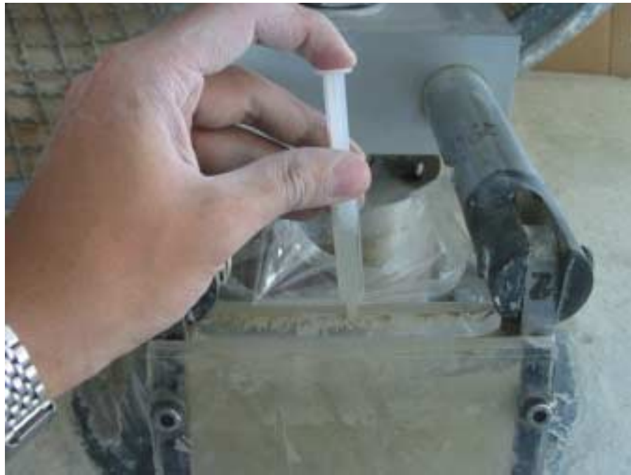
Foto 3.3: Extracción manual del agua proveniente de la consolidación de la mezcla binaria.
