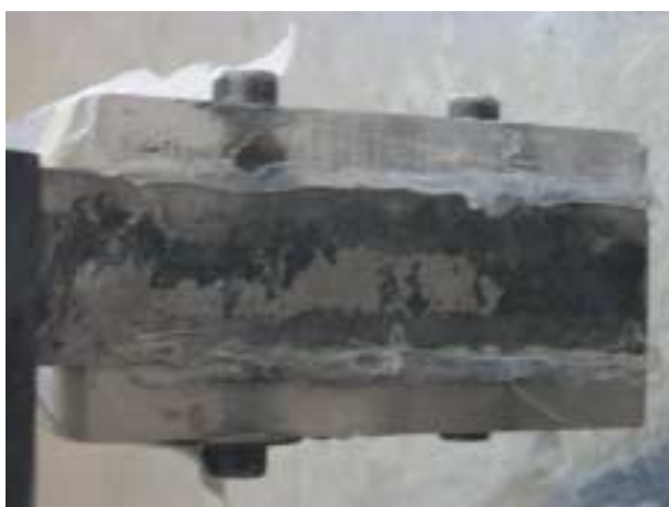
Foto 3.12: Sellado de los puntos de contacto entre el acrílico y el contenedor con silicona.
