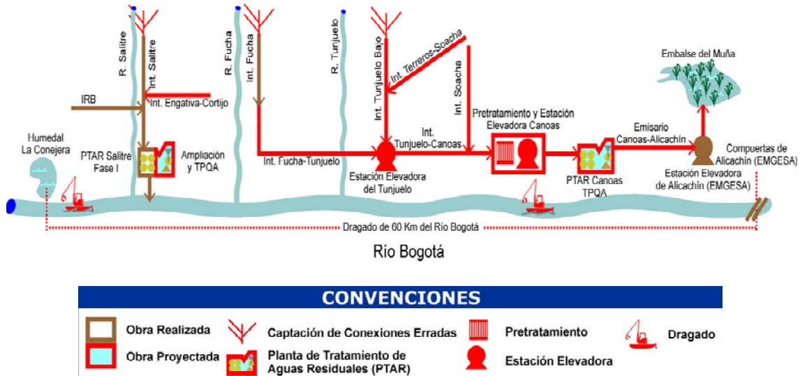
Figura 1 - Esquema de saneamiento para la cuenca media. (Adaptado de EAAB, 2004).
