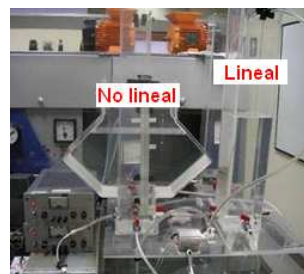
Figure 19: Disposición de los tanques de prueba
