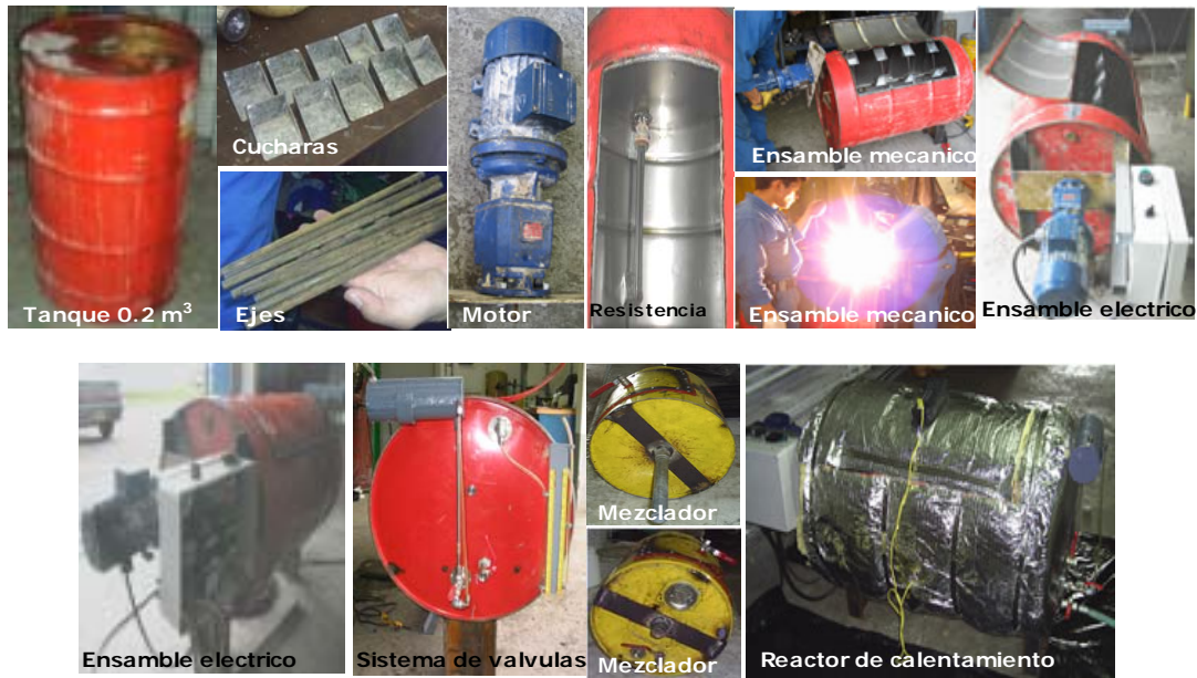
Figura 5. Materiales y proceso constructivo de reactor de calentamiento.
