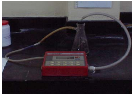
Figura 8. Analizador de gases infrarrojo marca Geotechnical Instruments.
