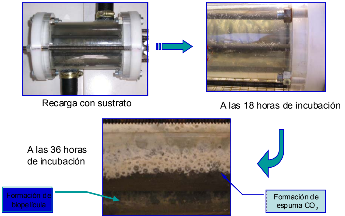
Figura 9. Cambios observados en los sustratos durante el experimento. (Fuente: Oscar Triviño, 2005)
