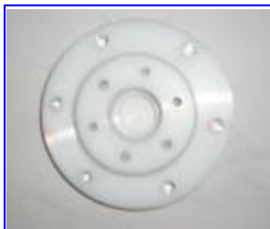
Figura 6. Tapas de celda de combustible microbiana de una sola cámara. (Fuente: Oscar Triviño, 2005)
