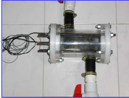
Figura 7. Celda de combustible microbiana de una sola cámara (Fuente Oscar Triviño, 2005).
