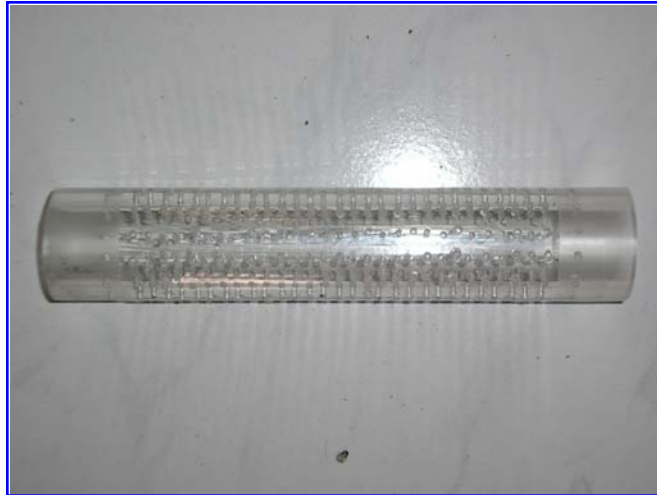
Figura 3. Soporte del cátodo. (Fuente Oscar Triviño 2005).
