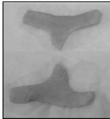
Figura 7. Probeta de Piel humana luego de haber fallado en prueba de tensión uniaxial.
