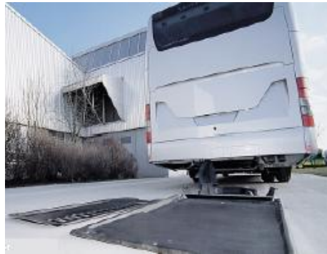
FIGURA 2. Paneles para autobuses hechos con compuestos de matriz poliéster y refuerzos de lino
