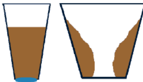
FIGURA 19. Dos de los inconvenientes presentados en la sección de alimentación a la salida de la tolva, en la izquierda la salida es demasiado cerrada y el material se atasca en la parte final, en la derecha la boca es demasiado abierta y el material tiende a quedarse pegado de las paredes [29]
