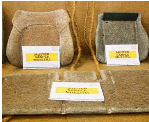
FIGURA 3. Aplicaciones para las fibras de coco en el proyecto liderado por POEMATEC en Brasil. En la imagen se muestran sillas hechas con fibras de coco y látex para vehículos Mercedes Benz Clase A
