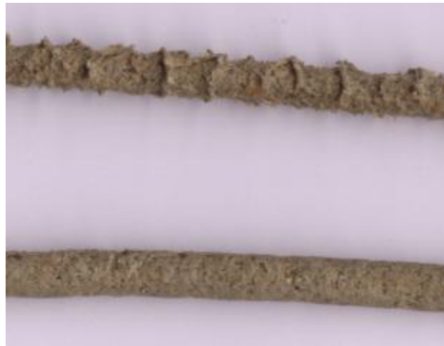
FIGURA 18. Defecto de piel de tiburón (arriba) sobre la superficie de una muestra de sección circular en comparación con una muestra sin defectos.
