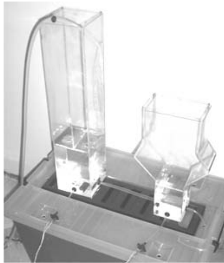
Figura 70. Fotografía del sistema de tanques acoplados implementado.
