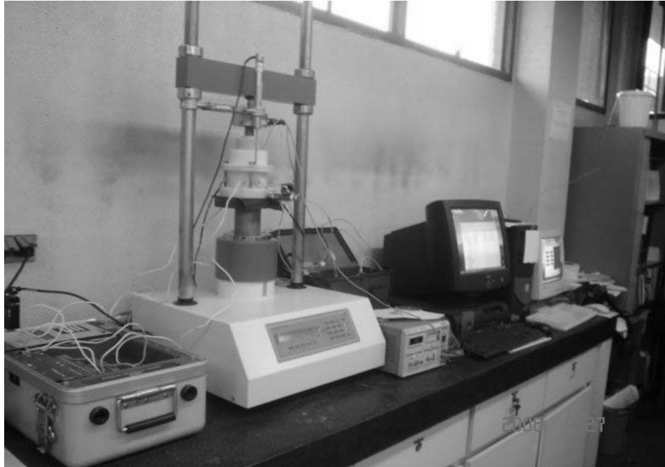
Figura 3.14. Montaje general de l ensayo de compresión uniaxial con velocidad de deformación controlada
