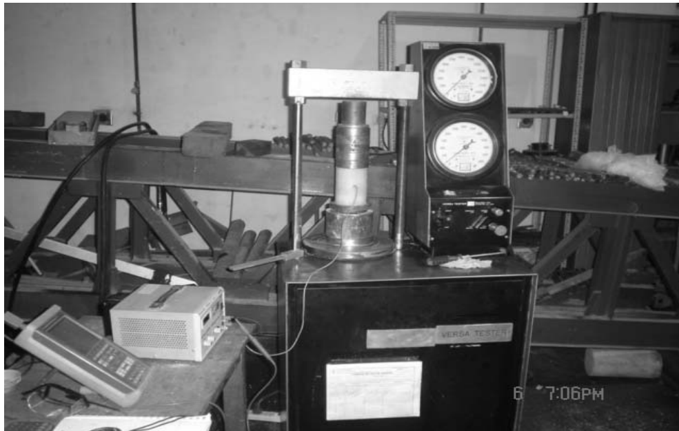
Figura 3.8. Montaje ensayo de calibración sensor de humedad
