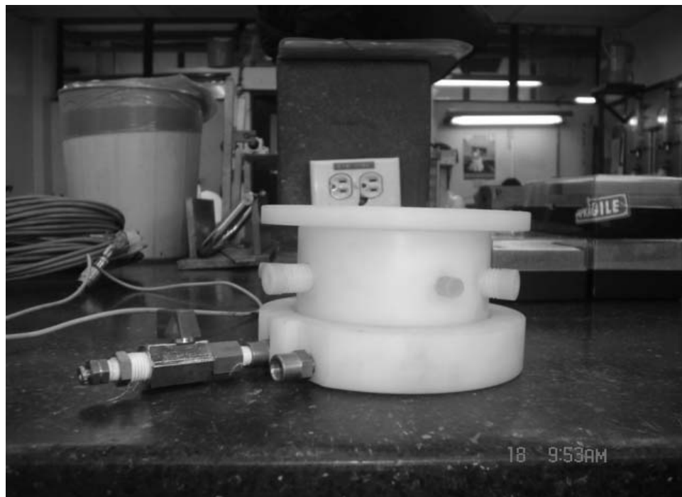
Figura 3.12. Detalle cámara de compresión uniaxial
