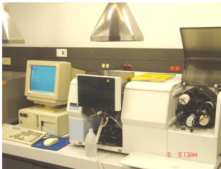
Figura 2. Espectrofotómetro de absorción atómica PERKIN ELMER 300. Laboratorio de análisis de espectrofotometría, Departamento de Química, Universidad de los Andes.
