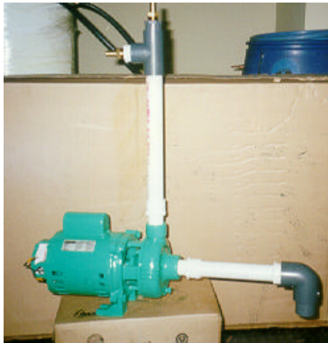
Foto 4.2 Motobomba y sus conexiones.
